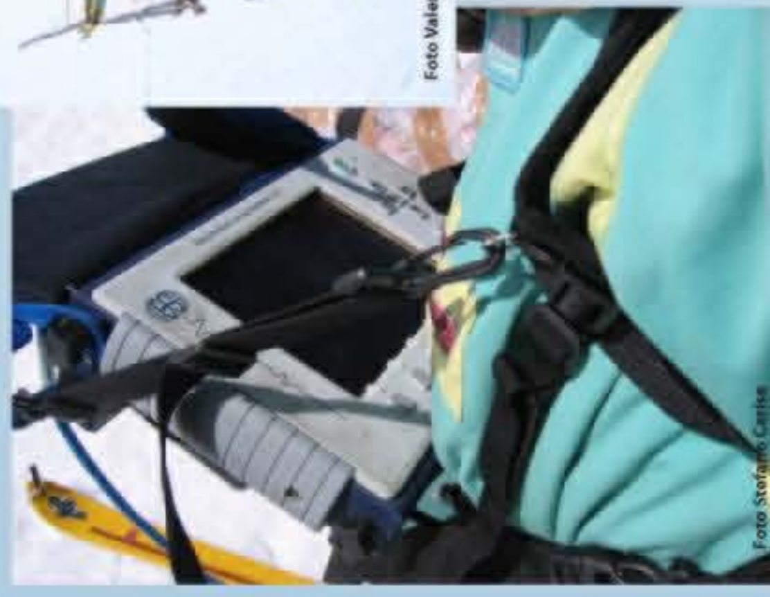
Unità di controllo e acquisizione, collegata ad antenna Radarteam con frequenza principale di 70 MHz.
