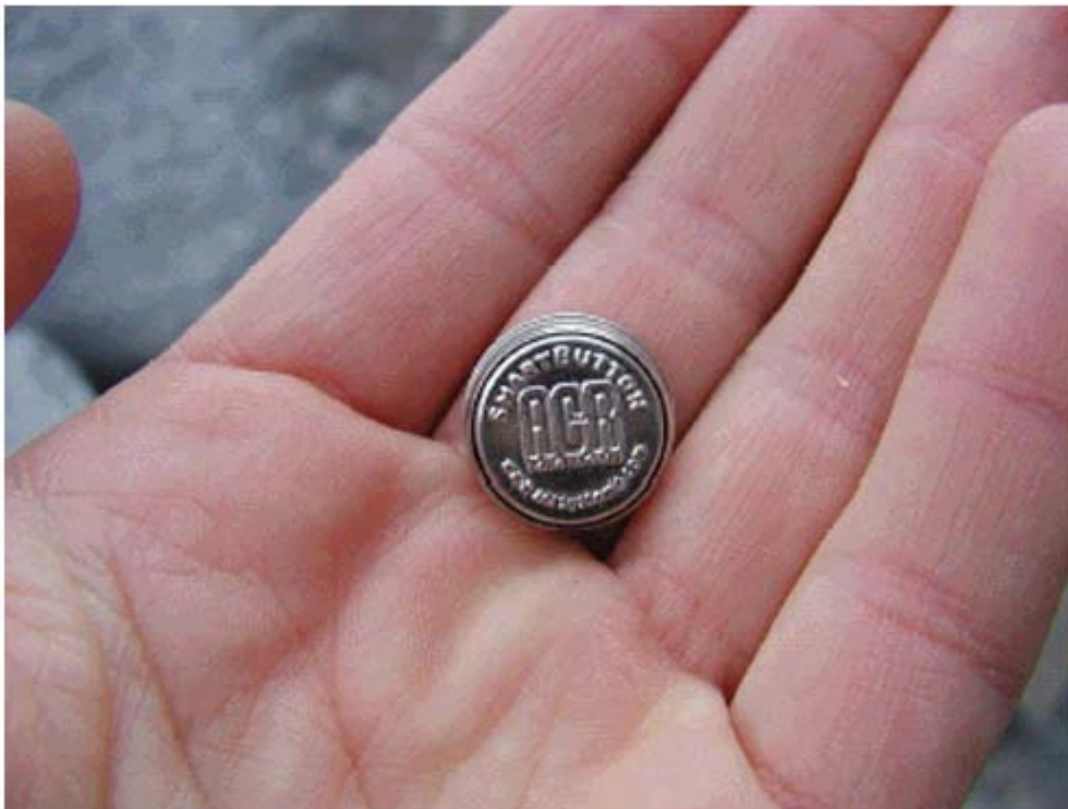
Uno dei due smart button collocati il 6 giugno 2003 sul ghiacciaio per rilevarne la temperatura giornaliera e rimossi il 17 ottobre 2003.
