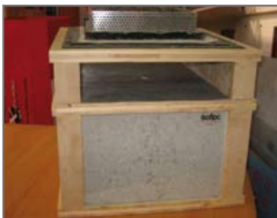
Sezione tipo di tetto piano in legno con soprastante giardino. Isolante in fibra di cellulosa da 25 cm. - www.lacasaditerra.com
