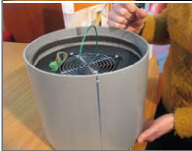
Nucleo di un apparecchio a ventilazione forzata con scambiatore di calore e filtro dell'aria, utile per un locale di normali dimensioni. Recupero di calore fino al 90 % circa. Consumo 2-6 watt. www.lacasaditerra.com
